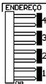
Todos os teclados saem de fábrica com o jumper na posição 1. Se for utilizar mais de um teclado (até 4 teclados), o segundo teclado deve ficar com o jumper na posição 2, conforme mostrado abaixo e assim por diante.
